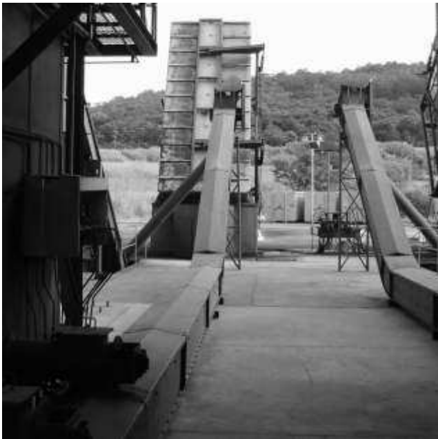
Transportador de corrente com curva para extração de cinzas e resíduos abrasivos.
