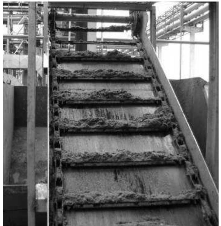
Transportador com corrente dupla com taliscas retirando resíduos de biomassa em processo de decantação em tanque.
